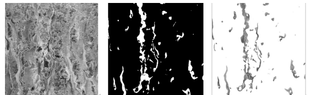
(a) 原图 (b) 最大类间方差得到流痕区域二 (c) 提取出的腐蚀区域图像
