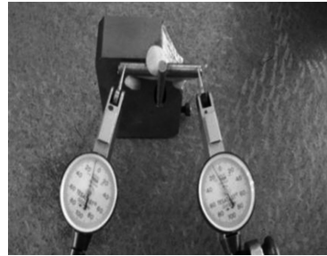
图3 橡皮泥贴合滚棒放置及其双表检测图片
