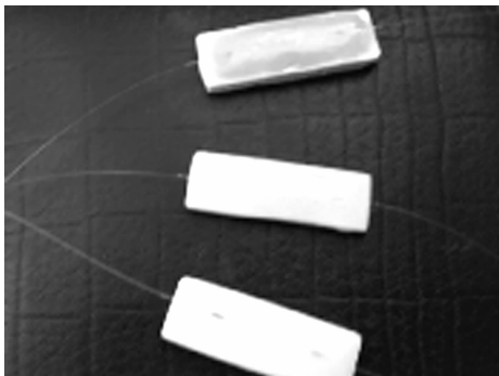
图6 负膨胀材料与 FBG 贴合效果图
