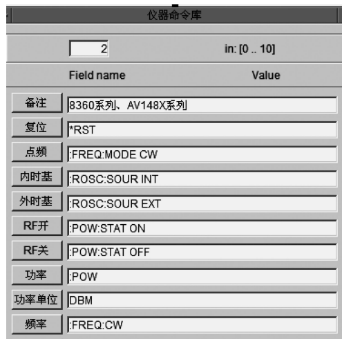
图 5 信号发生器自动校准软件的程序命令库
