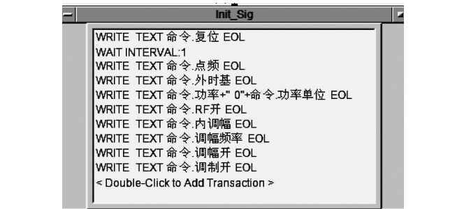
图 7 信号发生器自动校准软件的调幅度测试程序图
