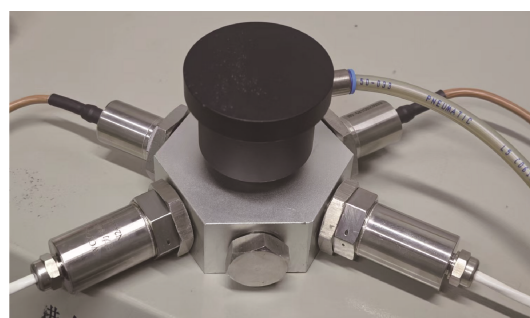
图5 待测试传感器安装示意图
