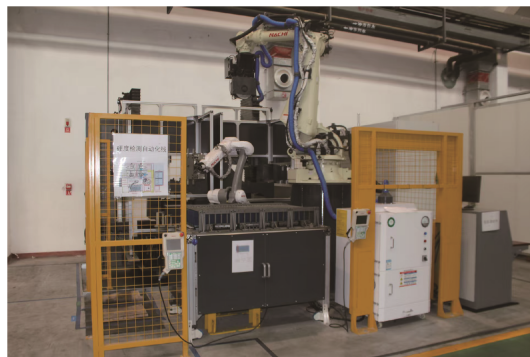
图2 叶片布氏硬度数字化在线检测产线
