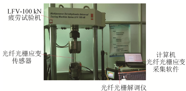
图3 疲劳加载试验系统
