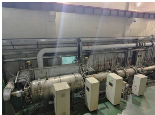
图 14 2 300 K 热校准风洞 Fig.14 2 300 K hot wind tunnel
