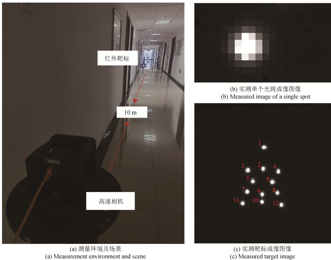
图 10 测量环境及实测单个光斑与靶标成像图像
