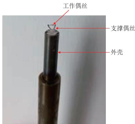
图5 热电偶的结构示意图
