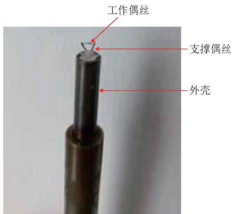
图5 热电偶的结构示意图
