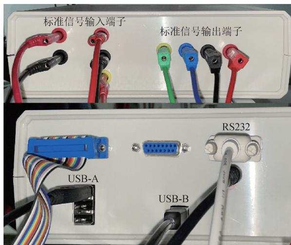
图5 接线切换器组成
