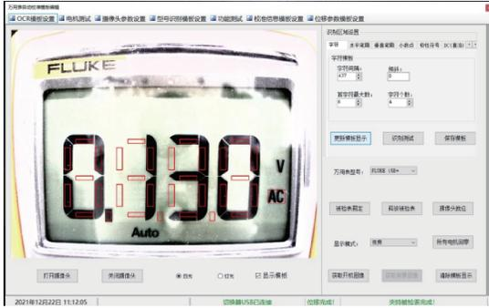
图8 7段数码管字符模板
