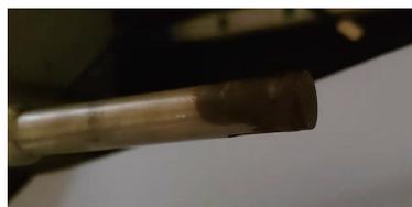
图 8 不锈钢材料探针高温测试后样品图
