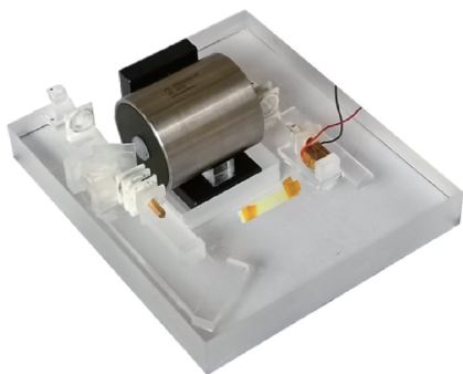
图7 北京大学研制的固态化GHz量级飞秒光纤激光器 [25]
