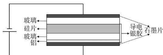
图3 第二次阳极键合结构简图
