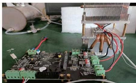
图2 双半导体制冷器主控温系统实物图
