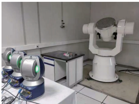
图 9 多基站测试的转台标准器实验装置
