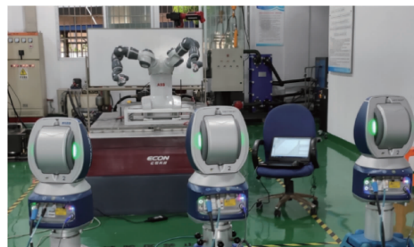
图 11 工业机器人的多基站测试实验系统
