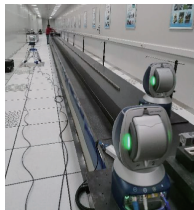
图7 多基站测试的直线导轨标准器实验装置
