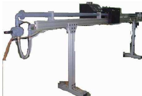
图3 美国 ENDEVCO 公司的 2973 型冲击加速度激励装置
