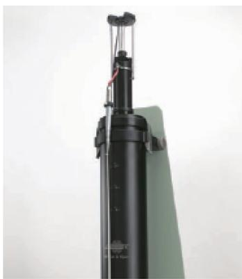
图2 商用驻波管法高声压发生器实物图
