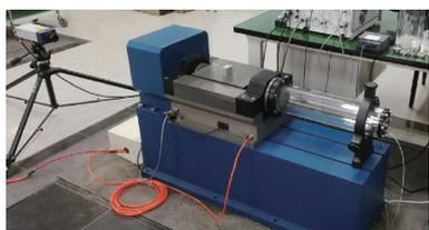
图8 高声压校准装置
