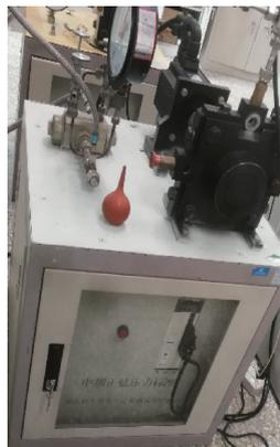
图 4 气流调制高声压发生器
