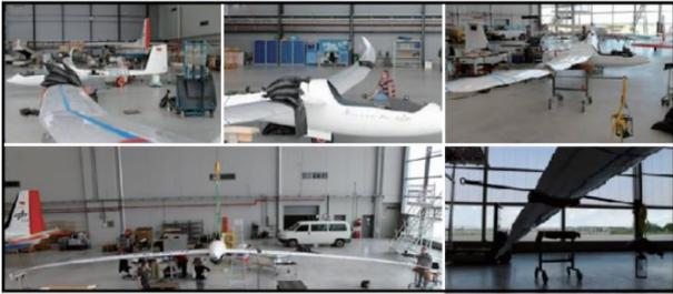
图 1 现场校准的各向结构载荷
