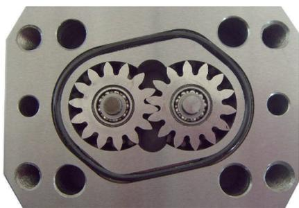
图1 圆柱齿轮流量计结构图
