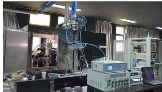
图3 弧光灯热流标定系统
