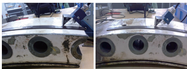
(a) 对无裂纹螺栓孔检测
