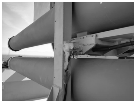
图7 导弹发射架及被涂敷保护的加速度计
