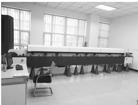
中图仪器与新疆计量院工程所合作研发的影像式钢卷尺/直尺检定仪
