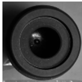
图 4 灌注 Pd-C 后的坩埚效果图
