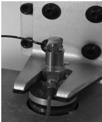
图 8 1175#传感器金属块转接安装方式
